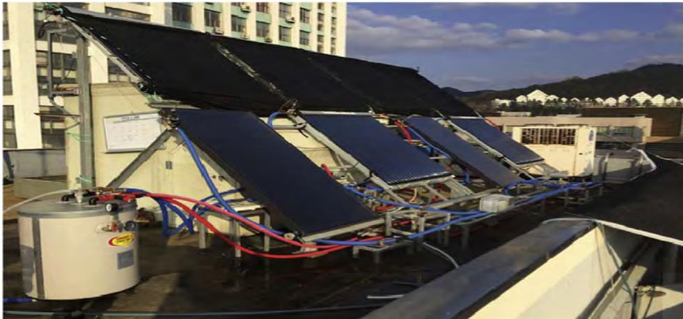
Fig. 5. Photographie de l'installation expérimentale du système de capteurs solaires à tube en U [23].
