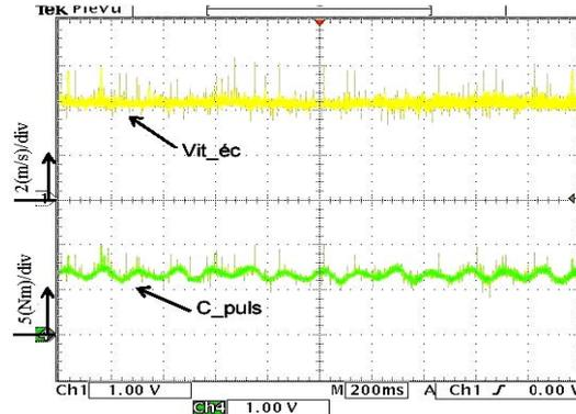
Fig. 6: Variation temporelle du couple pulsatoire et la vitesse de l'écoulement – cas d'une turbine
