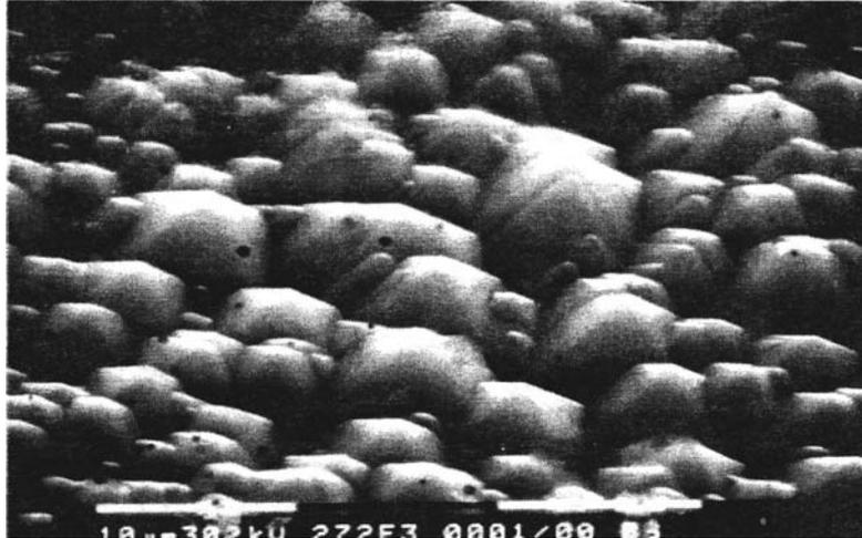
Photo 1: Etat de surface d'une plaquette de silicium texturée à l'aide d'une solution à base de NaOH
