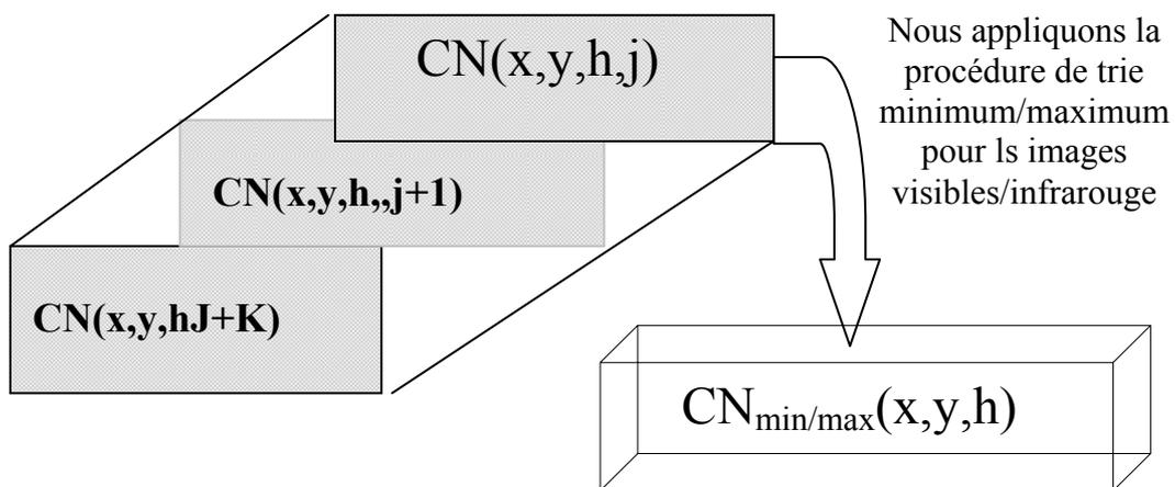
Fig. 3: Algorithme de tri est appliqué sur un mois d’images. Pour chaque pixel nous retenons le compte numérique minimal / maximal. L’image résultante est une image composite des radiances non prises pour les mêmes jours.
