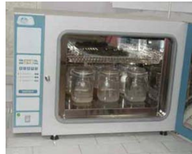
Fig. 1: Dispositif expérimental pour la mesure des isothermes de sorption
