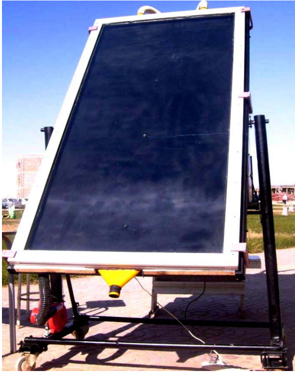
Fig. 3: Capteur solaire plan à air exposé au soleil
