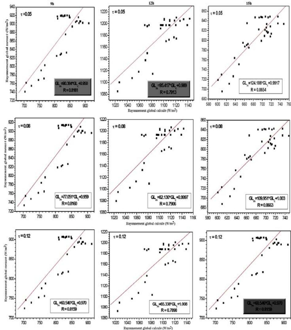
Fig. 2: Comparaison entre le rayonnement global calculé et mesuré pour différentes valeurs de  $\tau_{ae}$  pendant six mois, de Mars à Août 1999
