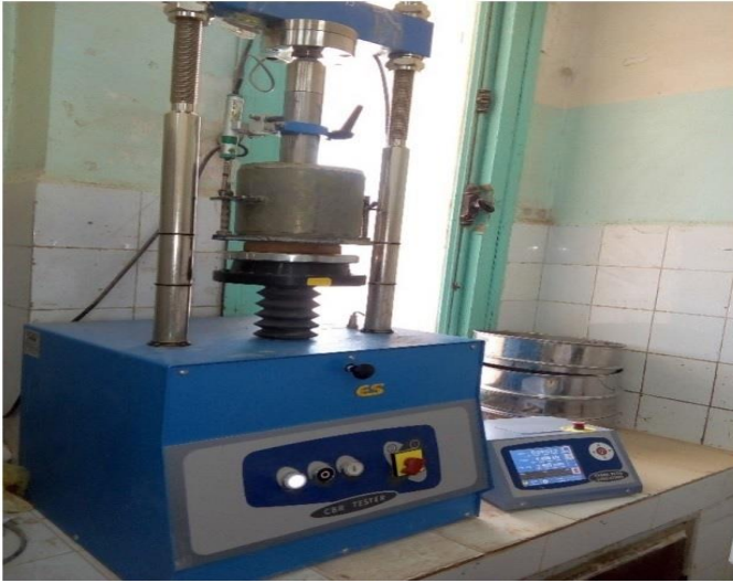
Fig. 10: Matériel d'essai du CBR
