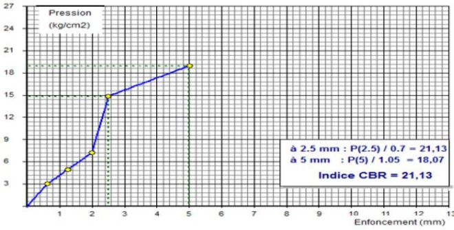
Fig. 23: Résultats de l'essai CBR immédiat après substitution du sable et le tuf 02
