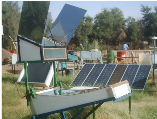
Fig. 3: Vue représentant le prototype cuiseur solaire à double exposition sur banc d'essai expérimental, 'URER/MS', Adrar
